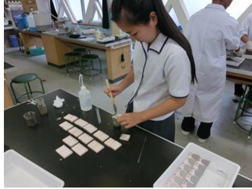
図 16 素焼き板に釉薬を塗る様子
