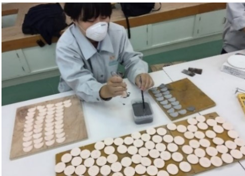
図 26 釉薬掛け作業
