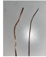
図6 導線の太さ (左 : 1.0mm、右 : 0.5mm)
