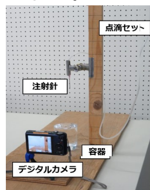
図1 水滴を滴下する実験装置
