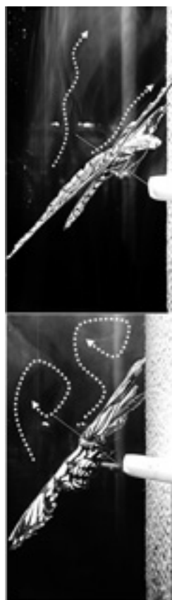
図5 流れ場の可視化実験（左：アサギマダラ、右：アゲハ）
