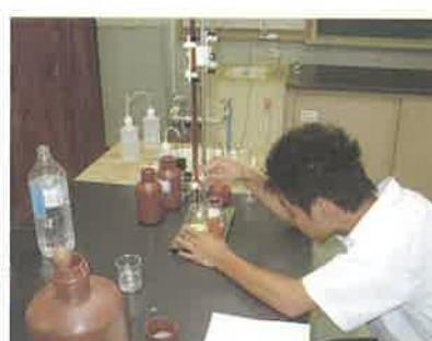
写真 3-2-54 モール法による滴定実験
