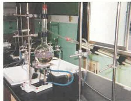
写真 3-2-13 ラベンダーの水蒸気蒸留
