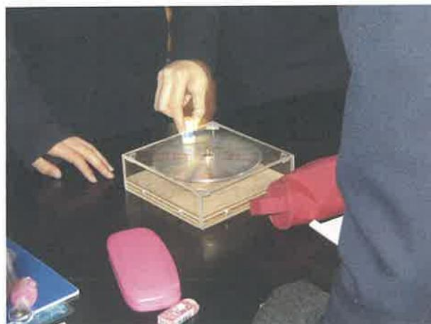
写真 3-3-5 誘導起電力の実験
