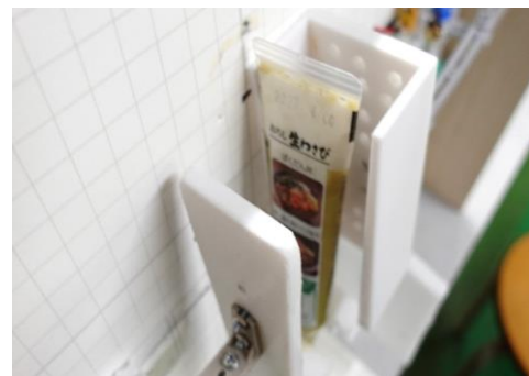
図2 チューブの形状に合わせたアーム正面図(左), 上から見た図
