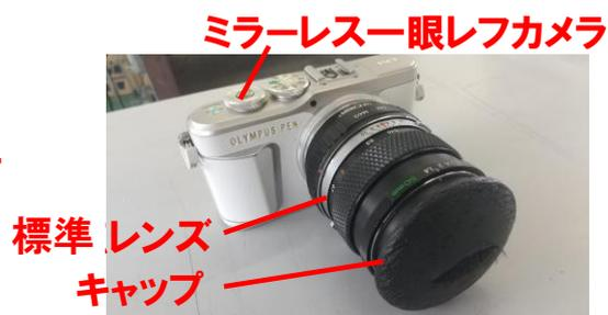
図 3 簡易眼球モデル測定装置
