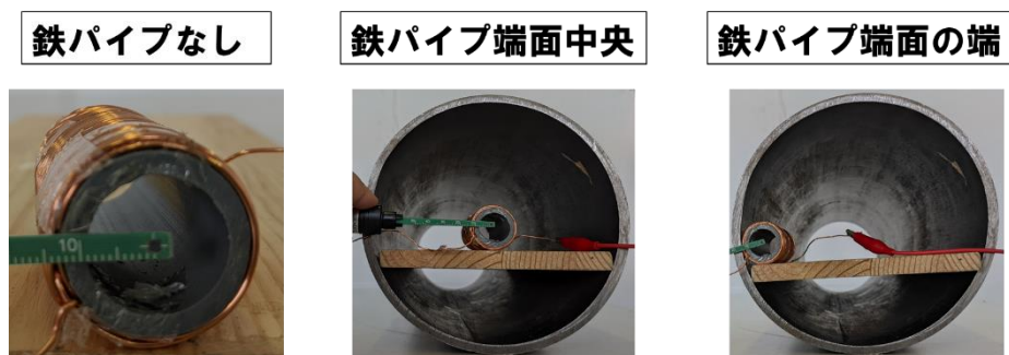
図 8 ソレノイドコイルの配置位置
