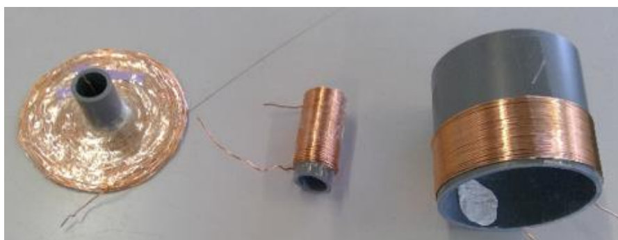
図15 作製した自己インダクタンス 107.5 \mu\text{H} のコイル
