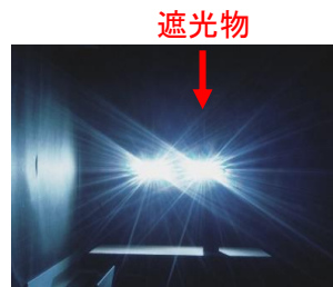
図41 遮光物を光源前に移動した場合 図40よりも回折光が減光されている。
