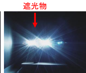
図42 測定装置を光源よりも右側に移動した場合 遮光物の像が見える。
