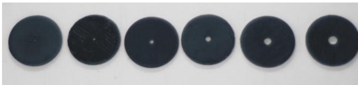
図 21 作製した瞳孔モデルキャップ 左から孔径 2 mm, 4 mm, 5 mm, 7 mm, 9 mm, 11 mm 遮光部は平面上である。
