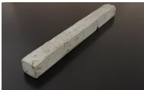
図13 製作したコンクリートブロック
