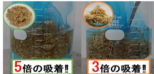
図10 乾燥ネギボウズの構造による吸油性の違いについての実験
