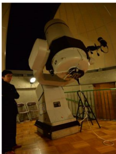
図3 口径 60cm の反射望遠鏡
